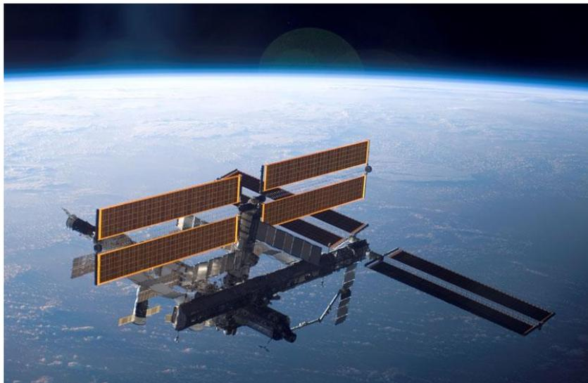
Если при этом ей сообщается дополнительная скорость  $\approx 2,5$  м/с, то её орбита приподнимается в среднем на 4 км, при этом среднее значение модуля скорости движения станции относительно Земли уменьшается. Чтобы удерживать станцию примерно на одной высоте, такие «толчки» нужно проводить даже чаще, чем раз в месяц.
