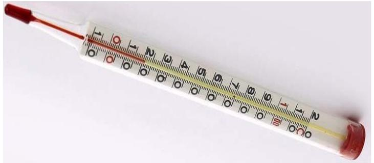
Решение: спирт прогревается через стеклянную оболочку. Если она нагревается в пламени быстро и сильно, то увеличивает свои размеры, и спирт сначала втягивается из капилляра внутрь емкости для его хранения. А затем нагрев спирта приводит к увеличению его объема, и часть спирта покидает оболочку емкости и выходит в капилляр.
