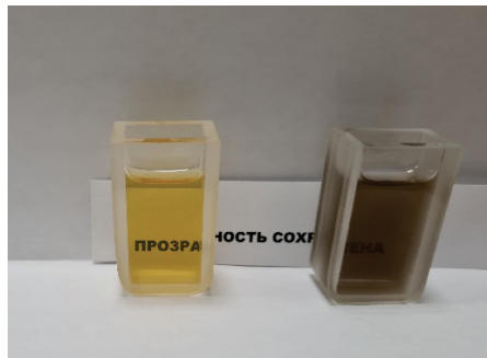
Рис. 9. Электронный спектр поглощения золя образца 6, стабилизированного смешением с полиакрилатом натрия, в сравнении с аналогом без полиакрилат-ионов (А) и вид коллоидов через 6 суток хранения при ст. у.: слева – с добавлением полиакрилата натрия, справа – без (Б)
