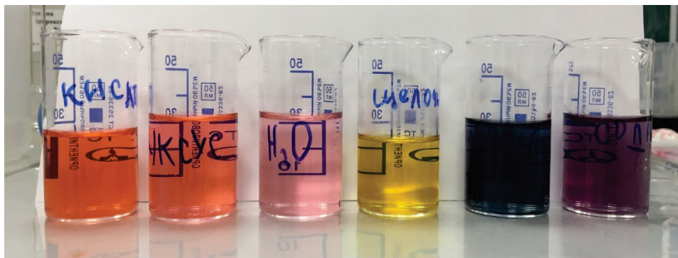
Рис. 13. Спектр изменения окраски ягодного экстракта в средах разной кислотности (слева направо от сильнокислой к нейтральной среде, далее от сильнощелочной к слабощелочной, последний раствор – пищевой соды)
