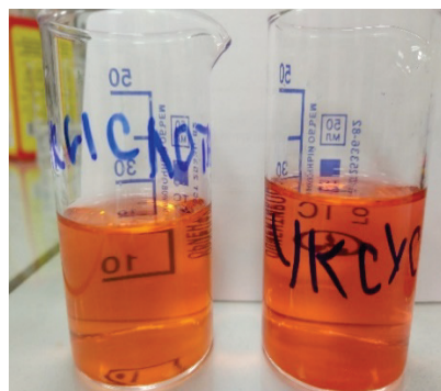
Рис. 11. Изменение окраски в сильной (слева) и слабой (справа) кислотах
