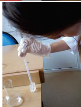
Рис. 2. Порция полиакрилата натрия для записи фонового спектра (А), перенос в кювету пробы золя серебра (Б)
