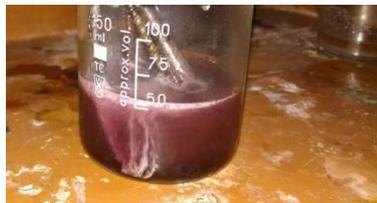
Рис. 1. Получение феррата (VI) калия электрохимическим методом
