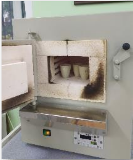
Рис. 25. Муфельная печь - ЭКСПС – 10, аналитические весы Przedsie biorstwo
