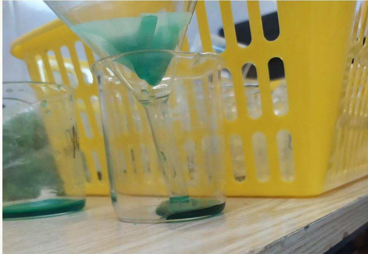
*Рис. 1. Процесс фильтрации раствора*
