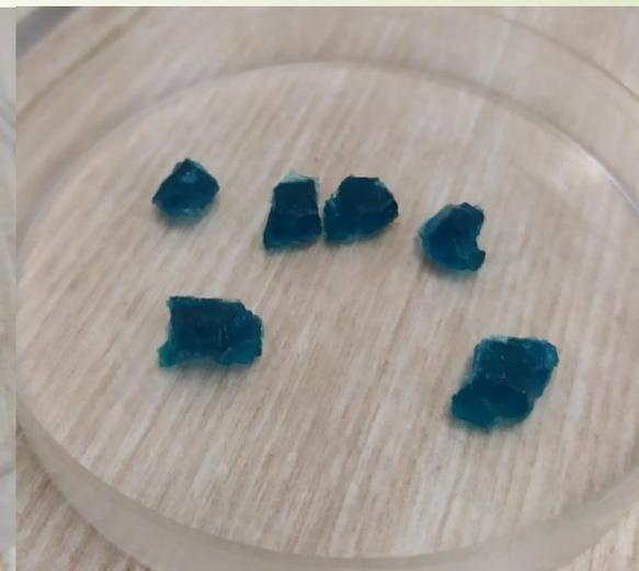
Рис.10. Кристаллы  $\text{NiSO}_4$  при  $28^\circ\text{C}$
