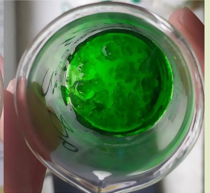
Рис.7 . Кристаллы, образующиеся из раствора №3 –  $\text{NiCl}_2$  при  $28^\circ\text{C}$
