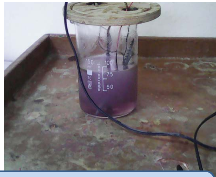
Фото3. Процесс электролиза феррата (VI) натрия
