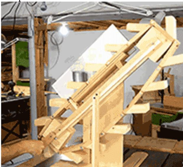
Решение: Пластины, на которые опирается пружина «слинки», проходят 1 м примерно за 4 секунды. То есть скорость движения пластин по величине равна 0,25 м/с. Сила, с которой пластины действуют на пружину, направлена вертикально вверх и равна по величине  $mg = 2$  Н. Сила и скорость составляют друг с другом угол  $45^\circ$ . Поэтому мощность равна:  $W = F \times V \times \cos(45^\circ) = 0,25 \times 2 / (2)^{0,5} \text{ Вт} \approx 0,35 \text{ Вт}$ .
