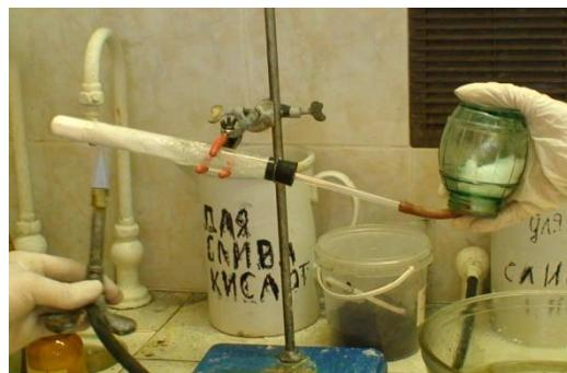
Рис. 6.11. Получение аммиака в лаборатории
