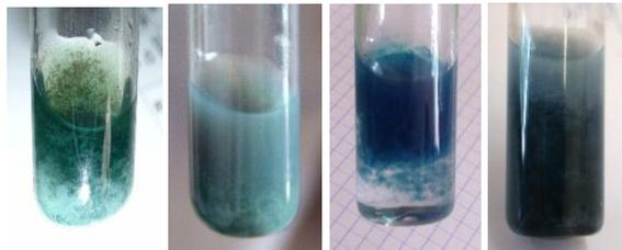
Рис. 10.41. Гидроксид хрома (III), выпадающий из разных растворов
