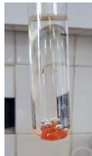
*Рис. 5.12. Взаимодействие серы с концентрированной серной кислотой при нагревании*
