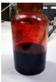
Рис. 4.5. Жидкий бром (над жидкостью – пары)
