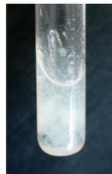
Рис. 8.3. Гидроксид алюминия
