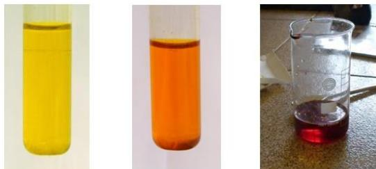
*Рис. 10.44. Растворы хромата  $\text{CrO}_4^{2-}$ , дихромата  $\text{Cr}_2\text{O}_7^{2-}$  и трихромата  $\text{Cr}_3\text{O}_{10}^{2-}$*
