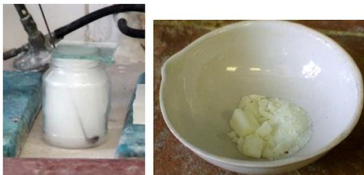
Рис. 4.17.  $PCl_5$  (слева) и  $PCl_5$  со следами  $PCl_7$  (справа)
