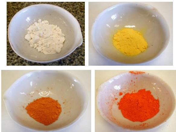
Рис. 7.34. Свинцовые белила  $(PbOH)_2CO_3$  и оксиды свинца: жёлтый  $PbO$  (глёт), оранжевый  $PbO$  (массикот), оранжевый  $Pb_3O_4$  (сурик)
