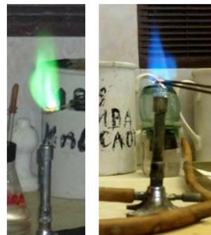
*Рис. 10.15. Окраска пламени, обусловленная ионами  $\text{Cu}^{2+}$  и  $\text{Cu}^+$*
