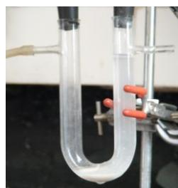
Рис. 7.26. Пропускание углекислого газа через известковую воду
