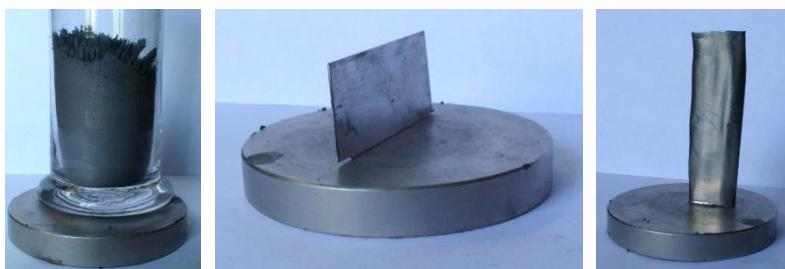
Рис. 10.17. Слева направо: железо, кобальт, никель. Пластиинки металлов, поставленные на магнит, удерживаются магнитным полем в вертикальном положении, а мельчайшие частицы железного порошка стремятся расположиться по силовым линиям
