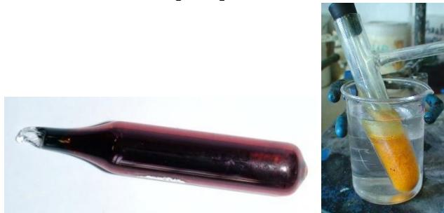
*Рис. 4.18. ICl (красная жидкость) и ICl<sub>3</sub> (твердое желтое вещество)*
