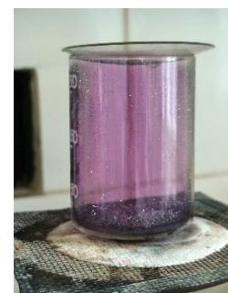
Другой миф, связанный с иодом – то, что он якобы не имеет жидкого состояния. Но не случайно в справочниках приведены температуры плавления и кипения, а не температура сублимации. Да, иод слишком легко переходит в газообразное состояние, и когда его мало, жидкое состояние
