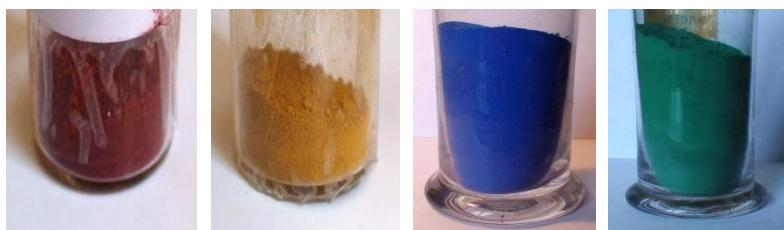
*Рис. 10.30. Красная охра ( $\text{гематит } \text{Fe}_2\text{O}_3$ ), жёлтая охра ( $\text{гётит } \text{FeOOH}$ ), тенарова синь  $\text{Co}(\text{AlO}_2)_2$ , зелень Ринмана  $\text{CoZnO}_2$*
