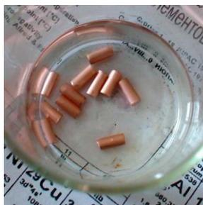
*Рис. 10.10. Медь, промытая кислотой*
