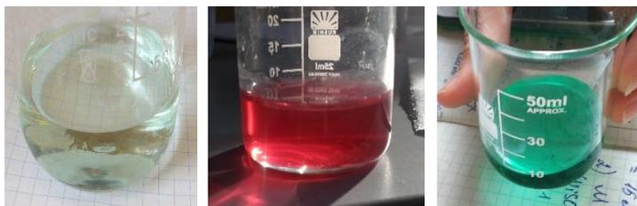
Рис. 10.23. Растворы солей  $\text{Fe}^{2+}$ ,  $\text{Co}^{2+}$ ,  $\text{Ni}^{2+}$
