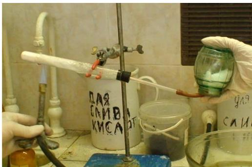
Рис. 6.11. Получение аммиака в лаборатории
