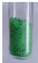
Рис. 10.51. Ванадиево-аммониевые квасцы  $\text{NH}_4\text{V}(\text{SO}_4)_2 \cdot 12\text{H}_2\text{O}$
