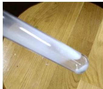
Рис. 6.12. При нагревании хлорида аммония, лежащего на дне пробирки, он разлагается, а на холодных стенках пробирки образуется снова
