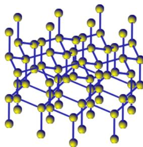
Рис. 7.3. Кристаллическая решётка лонсдейлита
