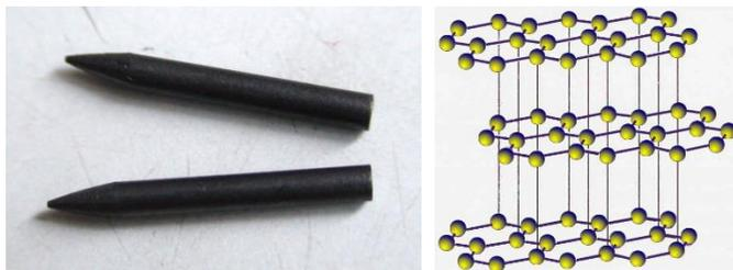
Рис. 7.4. Внешний вид и кристаллическая решетка графита
