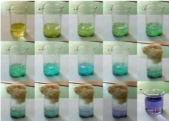
Рис. 10.49. Восстановление ванадата (восстановитель –  $Zn + HCl$ ). Голубой  $V(IV)$  постепенно образуется даже при доступе воздуха, а при изоляции от воздуха получается зеленый  $V(III)$  и фиолетовый  $V(II)$
