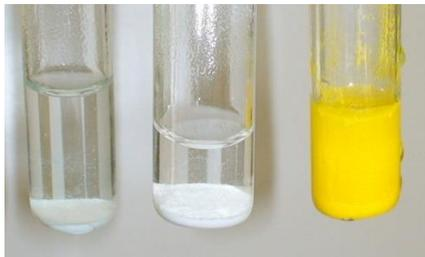
Рис. 4.22. Осадки  $\text{PbCl}_2$ ,  $\text{PbBr}_2$ ,  $\text{PbI}_2$
