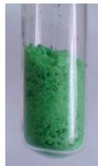
Рис. 10.51. Ванадиево-аммониевые квасцы  $\text{NH}_4\text{V}(\text{SO}_4)_2 \cdot 12\text{H}_2\text{O}$
