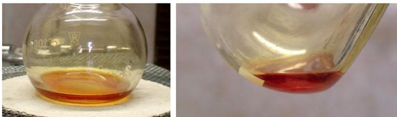
Рис. 5.11.  $\text{SCl}_2$  (слева) и  $\text{S}_2\text{Cl}_2$  (справа)
