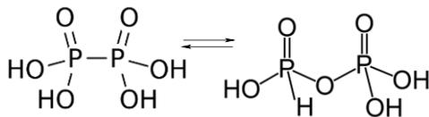
Рис. 6.32. Слева – фосфорноватая кислота, справа – изофосфорноватая
