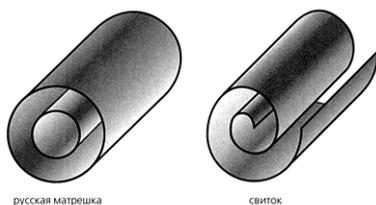
Рис. 7.12. Схема двуслойной нанотрубки и нанотрубки переменного радиуса
