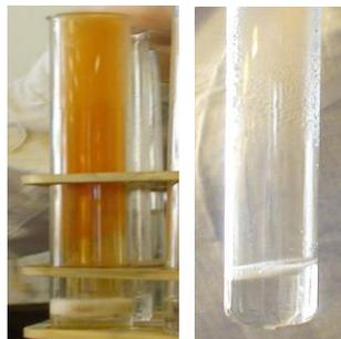
Рис. 6.22. Взаимодействие магния с концентрированной и разбавленной азотной кислотой
