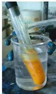
*Рис. 4.18. ICl (красная жидкость) и ICl<sub>3</sub> (твердое желтое вещество)*
