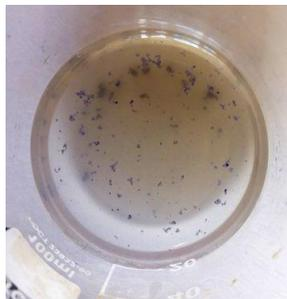
*Рис. 10.9. Частички серебра, образовавшиеся в осадке  $\text{AgCl}$  на свету*
