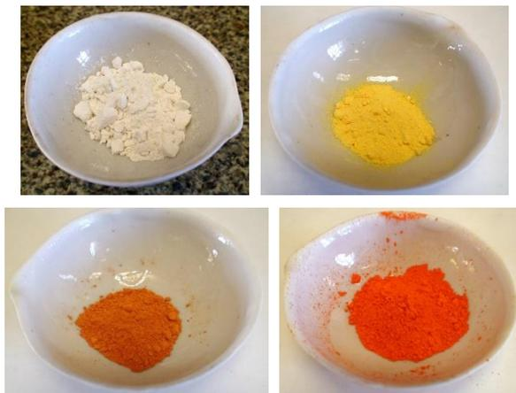
Рис. 7.34. Свинцовые белила  $(PbOH)_2CO_3$  и оксиды свинца: жёлтый  $PbO$  (глёт), оранжевый  $PbO$  (массикот), оранжевый  $Pb_3O_4$  (сурик)
