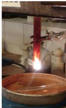
Рис. 4.15. Взаимодействие алюминия с бромом
