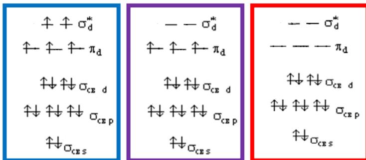
Рис. 10.4. Слева направо: энергетические диаграммы молекулярных орбиталей  $Mn^{+2}$  (два наполовину заполненных уровня),  $Mn^{+4}$  (один наполовину заполненный уровень + один свободный),  $Mn^{+7}$  (два свободных уровня)
