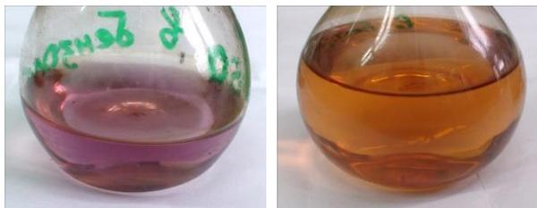
Рис. 7.10. Растворы  $\text{C}_{60}$  и  $\text{C}_{70}$  в бензоле
