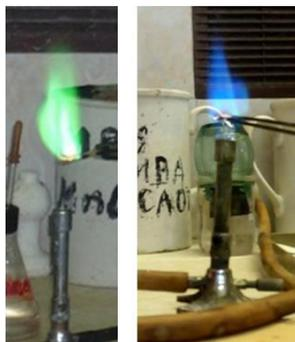
Рис. 10.15. Окраска пламени, обусловленная ионами  $\text{Cu}^{2+}$  и  $\text{Cu}^+$
