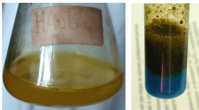
Рис. 10.16.  $H[AuCl_4]$  и окисление  $Cu(OH)_2$  пероксидом водорода
