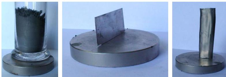
Рис. 10.17. Слева направо: железо, кобальт, никель. Пластинки металлов, поставленные на магнит, удерживаются магнитным полем в вертикальном положении, а мельчайшие частицы железного порошка стремятся расположиться по силовым линиям
