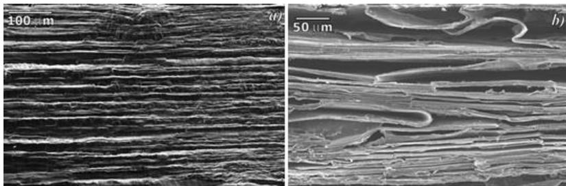
Рис. 7.21. Изображения графита (слева) и пенографита (справа) в сканирующем электронном микроскопе<sup>7</sup>
