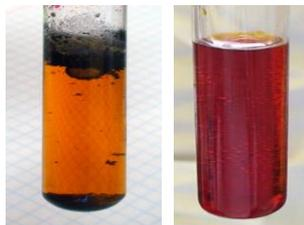
Рис. 4.13. Реакция бромной воды с раствором KI: слева – редкий случай (достигнута эквивалентность, выделился иод), справа – обычный результат (образование комплекса)
