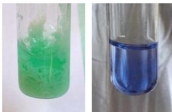
Рис. 10.20.  $\text{Ni}(\text{OH})_2$  и  $[\text{Ni}(\text{NH}_3)_6]^{2+}$
