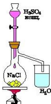
Рис. 4.20. Схема прибора для получения хлороводорода
