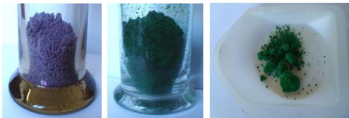
Рис. 10.40. Соединения с комплексными ионами  $[\text{Cr}(\text{H}_2\text{O})_6]^{3+}$ ,  $[\text{Cr}(\text{H}_2\text{O})_5\text{Cl}]^{2+}$ ,  $[\text{Cr}(\text{H}_2\text{O})_4\text{Cl}_2]^+$
