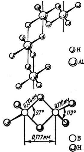
Рис. 8.5. Структура  $(\text{AlH}_3)_x$  и  $\text{B}_2\text{H}_6$
