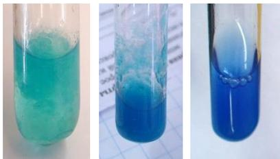
Рис. 10.11. Основная соль меди (II),  $\text{Cu}(\text{OH})_2$  и  $\text{Na}_2[\text{Cu}(\text{OH})_4]$
