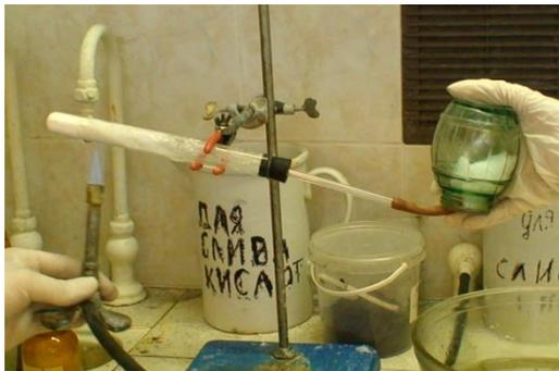
Рис. 6.11. Получение аммиака в лаборатории
