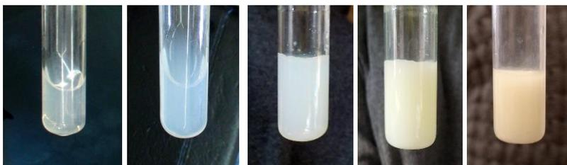
*Рис. 5.13. Последовательное укрупнение частиц серы при разложении тиосерной кислоты*
