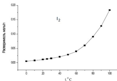
Рис. 4.11. Температурные зависимости растворимости хлора (слева) и иода (справа) в воде
