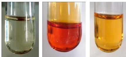
*Рис. 4.8. Водные растворы галогенов: хлорная, бромная и иодная вода (слева направо)*
