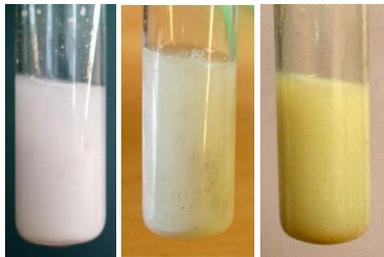
Рис. 4.21. Осадки  $\text{AgCl}$ ,  $\text{AgBr}$ ,  $\text{AgI}$
