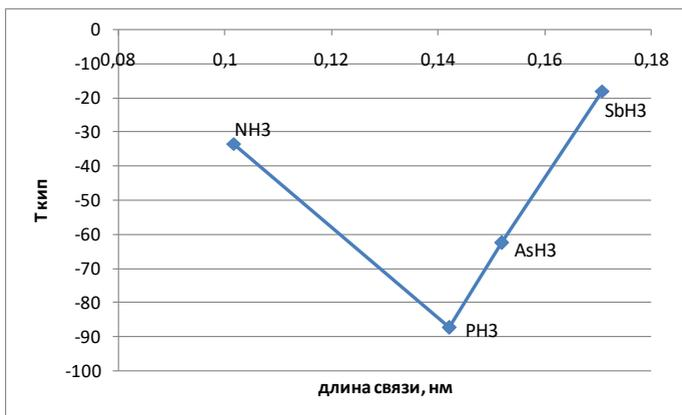
Рис. 6.10. Зависимость температур кипения простейших водородных соединений элементов главной подгруппы V группы от длины связи Э–Н
