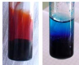
Рис. 10.28. Роданидные комплексы Fe (III) и Co (II) (последний – в концентрированном растворе)
