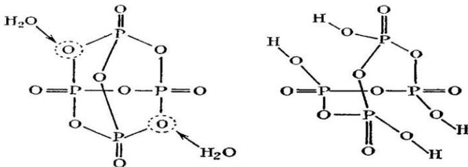
Рис. 6.26. Схема образования тетрамера метафосфорной кислоты
