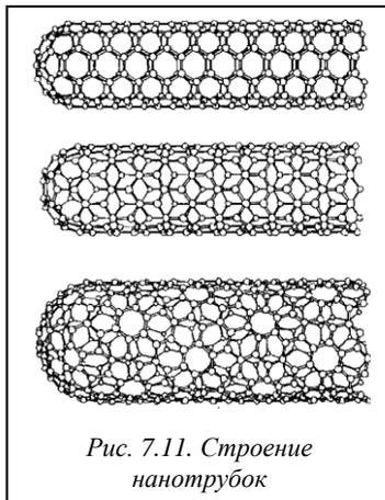
Рис. 7.11. Строение нанотрубок
