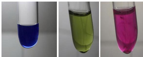
Рис. 5.19. Слева направо:  $\text{S}_8^{2+}$  в олеуме,  $\text{Se}_n^{2+}$  и  $\text{Te}_4^{2+}$  в концентрированной серной кислоте
