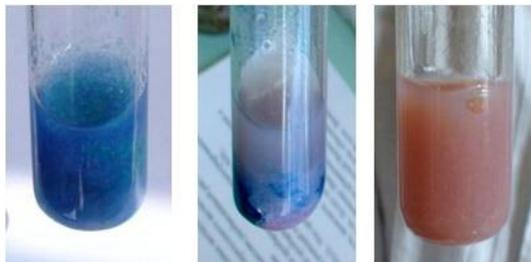
Рис. 10.21. Переход основной соли кобальта в гидроксид
