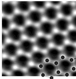
Рис. 7.5. Изображение графена в электронном микроскопе
