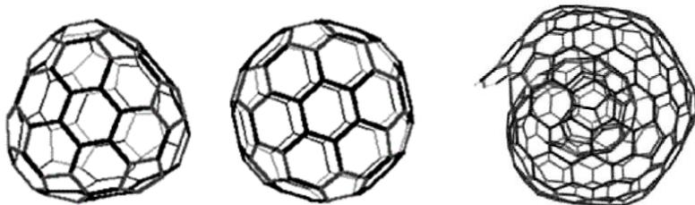
Рис. 7.8. Изомеры  $C_{84}$
