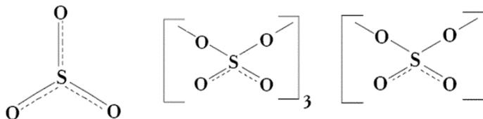
Рис. 5.16. Строение модификаций SO<sub>3</sub>: слева направо –  $\alpha$ -SO<sub>3</sub> (газ),  $\beta$ -SO<sub>3</sub> (жидкость) и  $\gamma$ -SO<sub>3</sub> (твёрдое белое вещество)
