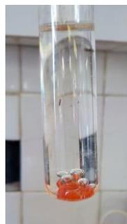
Рис. 5.12. Взаимодействие серы с концентрированной серной кислотой при нагревании
