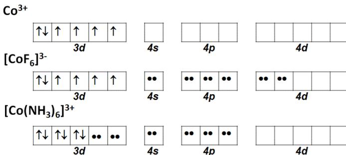
Рис. 10.3. Электронное строение иона  $Co^{3+}$  и его комплексных соединений. Стрелками показаны собственные электроны центрального иона, точками – электронные пары лигандов
