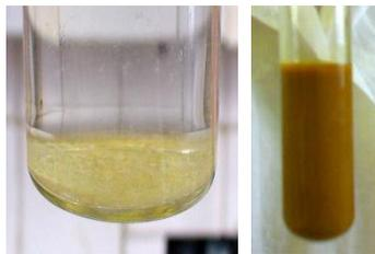
Рис. 10.12. Образование  $\text{Cu}(\text{OH})_2$  при добавлении щелочи к  $\text{CuCl}_2$  и при окислении глюкозы гидроксидом меди (II)
