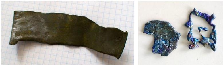
Рис. 7.18. Свинцовая пластина и образцы свинца, полученные кристаллизацией расплава на воздухе (окраска обусловлена поверхностным окислением)
