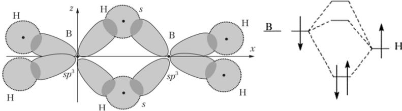
Рис. 8.6. Схема образования связей в диборане и диаграмма молекулярных орбиталей для трёхцентральной связи B – H – B
