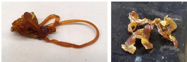
Рис. 5.9. Пластическая сера и ее начинающийся переход в ромбическую
