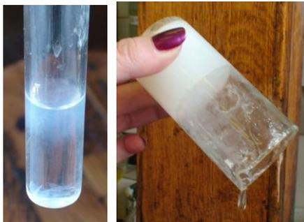
Рис. 7.29 Золь, образующийся при переходе ортокремниевой кислоты в мета­кремниевую (слева) и желе мета­кремниевой кислоты (справа)
