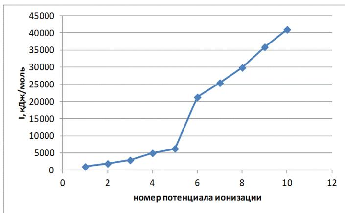
Рис. 1.5. Последовательные потенциалы ионизации фосфора
