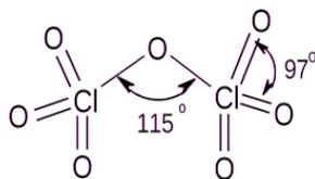
Рис. 4.24. Строение  $\text{Cl}_2\text{O}_7$
