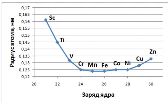
Рис. 10.2. Зависимость атомных радиусов от заряда ядра для переходных элементов 4-го периода
