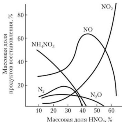
Рис. 6.23. Состав продуктов восстановления азотной кислоты в реакции с железом
