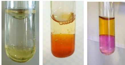
Рис. 4.9. Экстракция хлора, брома и иода (слева направо) из водного раствора в  $CCl_4$  (слой растворителя внизу)
