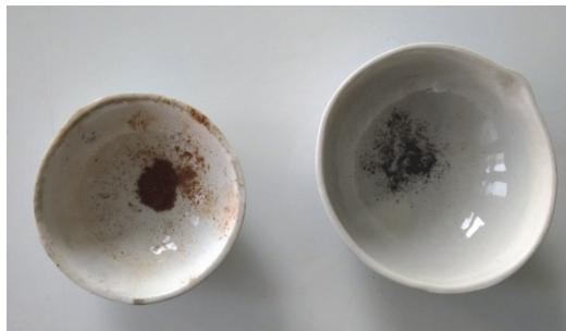
Одна из подготовленных проб грунта (слева) и железо, полученное ее восстановлением водородом (справа)
