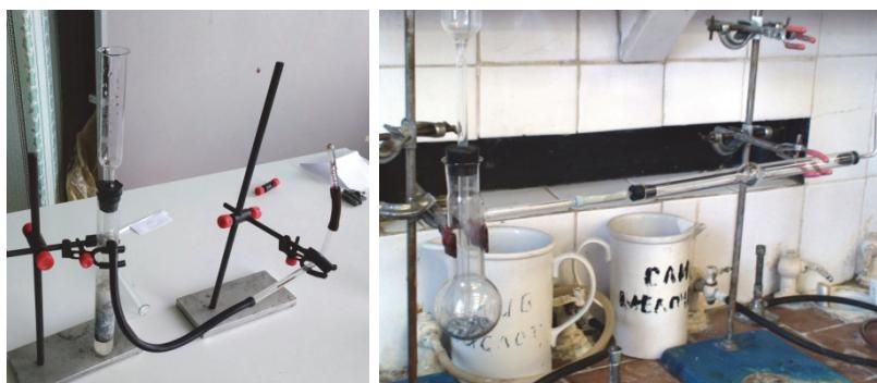
Лабораторные приборы для восстановления оксида металла водородом (на каждом фото: слева – сосуд для получения водорода, правее – реакционная трубка, в середине которой находится оксид, справа – отвод с медной спиралью для исключения проскока пламени, на конце которого водород поджигается)
