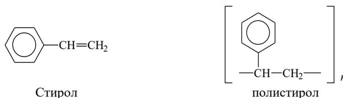
Полистирол – бесцветный прозрачный хрупкий материал – применяют для электроизоляции, для изготовления корпусов различных электроприборов, игрушек, пластиковой посуды, ручек и т. д.
