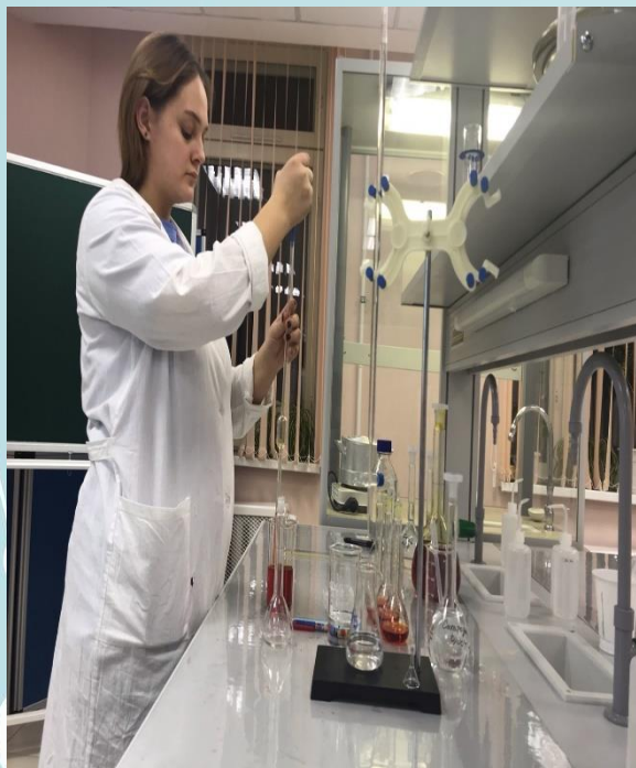
Рис. 1 В 7 мерных колб внесли по 25 г/см 3 раствора дихромата калия.
