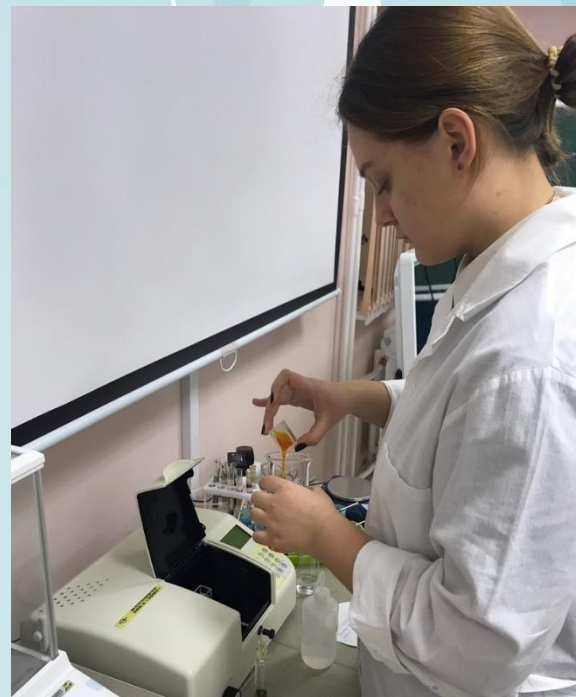
Рис. 2 Измерение оптической плотности на спектрофотометре.
