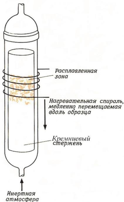
Рис. 3. Схема зонной плавки
