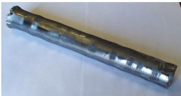
Рис. 4. Монокристаллический кремний, полученный методом Чохральского
