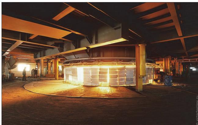
Рис. 1. Дуговая электротепелка для выплавки кремния на заводе *Silicium Kazakhstan* ([https://s00.yaplakal.com/pics/pics\\_original/3/2/4/312423.jpg](https://s00.yaplakal.com/pics/pics_original/3/2/4/312423.jpg))
