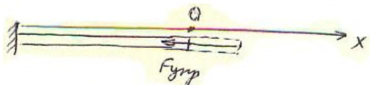
Направим ось  $X$  от первого конца стержня ко второму концу и примем за ноль на оси  $X$  положение частицы в ситуации, когда стержень не деформирован. Тогда в силу закона Гука упругая сила, действующая на частицу, при малых деформациях растяжения или сжатия стержня может быть записана в виде:
