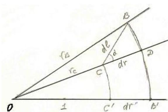
одном из таких элементарных участков  $CB$ . По определению  $\delta A_{CB} = F_C dl \cos(\alpha)$ , где  $F_C$  – величина силы  $F$  в точке  $C$ . Проведем дуги окружностей с центром в т.  $O$  радиусами  $OC$  и  $OB$ . Они пересекут лучи  $OC$  и  $O1$  в точках  $C, D$  и  $C', B'$  соответственно (см. рисунок). Так как  $dl$  мало, то угол  $\angle COB$  тоже мал, и, следовательно, угол  $\angle ODB$  равнобедренного (по построению) треугольника  $DOB$  является почти прямым. Поэтому:
