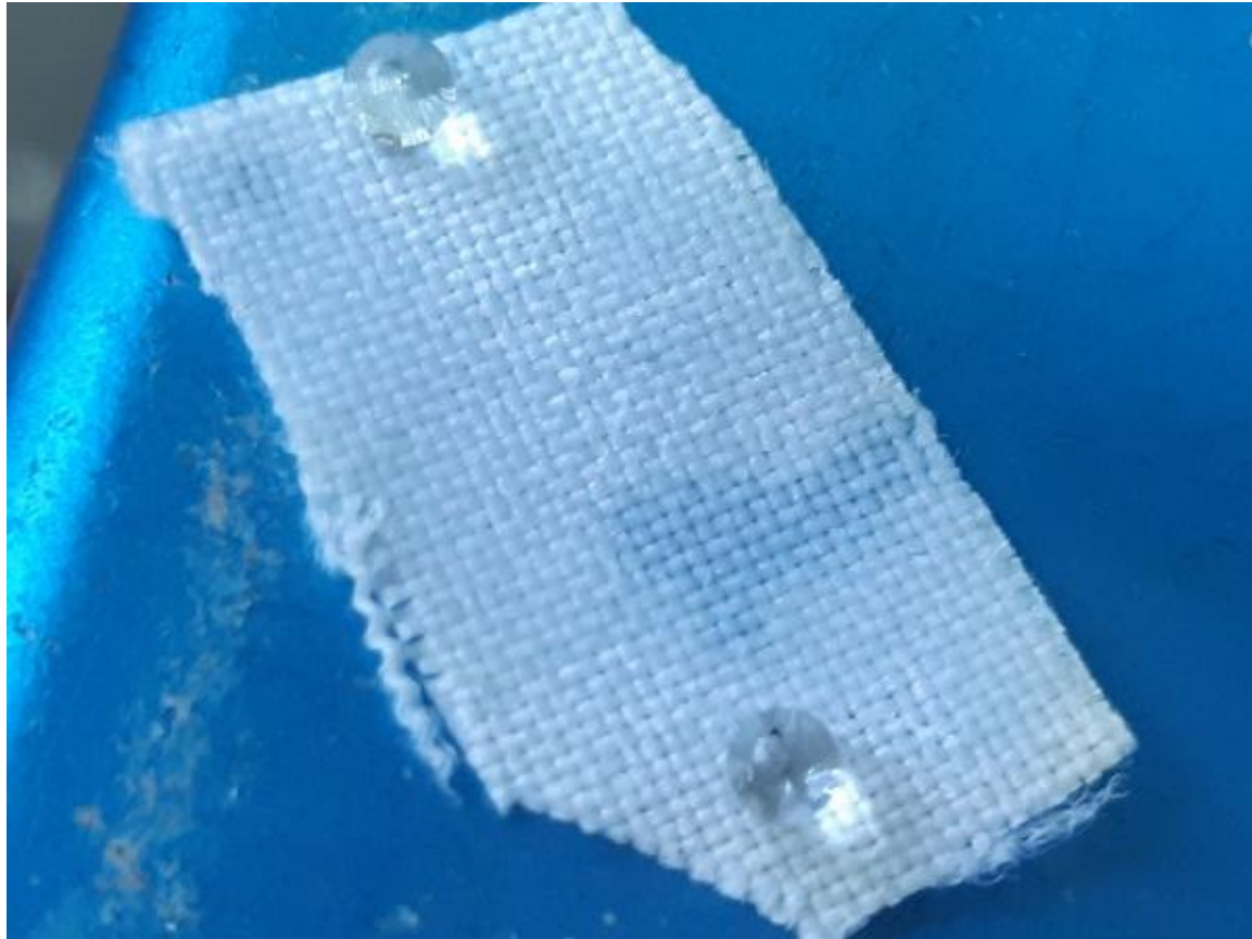
Рис. 11. Пример неравномерного осаждения CF_3 -полимера на ткань
