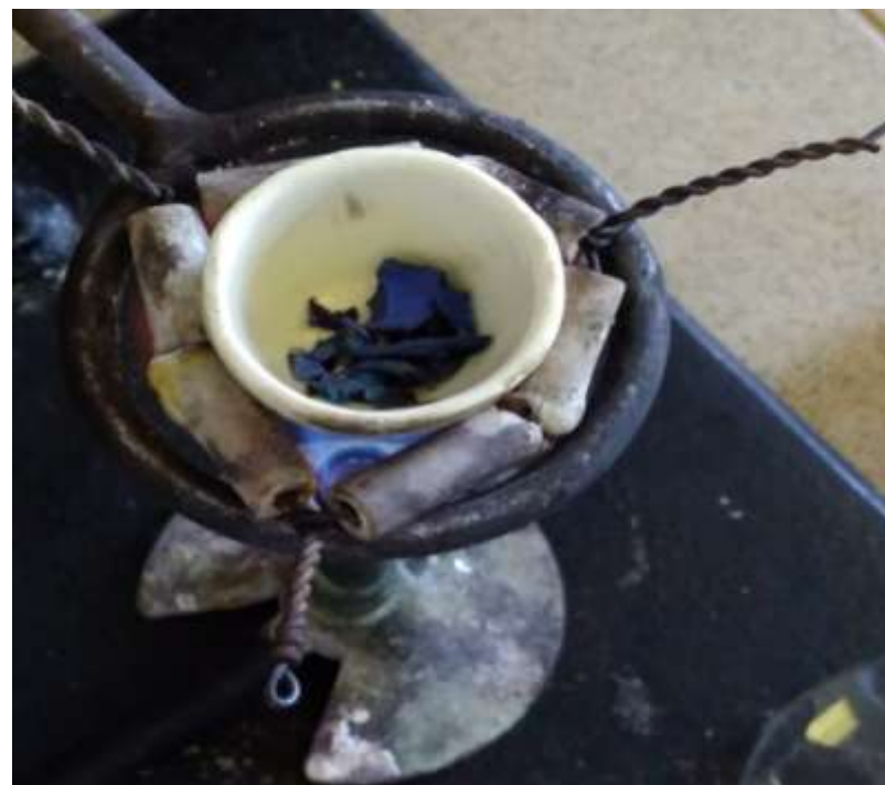
Прокаливание кристаллогидрата фосфата кобальта
