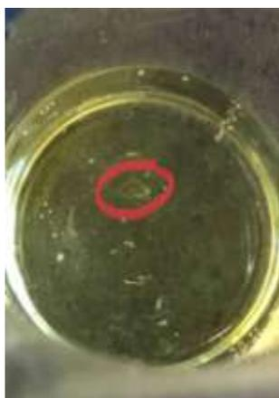
Рис. 4. Маслянистые капли расплавленной серы
