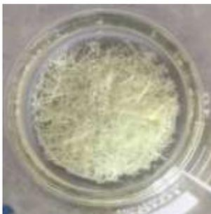
*Рис. 12. Процесс перехода моноклинной серы в ромбическую (кристаллы теряют форму и крошатся)*
