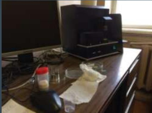
Лазерный агрегометр-деформометр LADE
