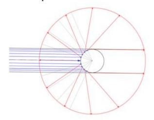
При отражение лучи пойдут по поверхности конуса, угол раствора которого равен ( $\pi$ -2 $\alpha$ ) рад. На рисунки показан этот механизм. (Синие стрелки- подающие лучи, а красные- отраженные.)
