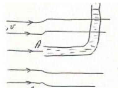
Именно это давление и показывает соединенный с трубкой манометр.
