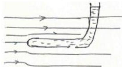
Рассмотрим теперь трубку с открытым передним концом, обращенным навстречу потоку жидкости. Так как жидкость внутри трубки неподвижна, то линия тока, упирающаяся в открытый конец трубки, обрывается в точке А и скорость жидкости в этой точке обращается в нуль. Обозначим давление в этой точке  $p_A$ , а давление и скорость потока на этой же линии тока вдали от трубки через  $p$  и  $v$ . Тогда согласно уравнению Бернулли:
