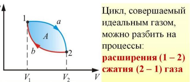
Цикл, совершаемый идеальным газом, можно разбить на процессы:
