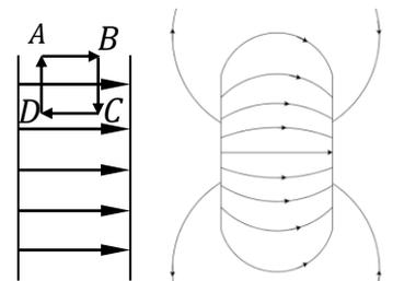
На самом деле электростатическое поле вблизи краев плоского конденсатора неоднородно и вне границ конденсатора поле не равно нулю, хоть и очень слабое. Нетрудно понять, что модель плоского конденсатора работает тем лучше, чем меньше отношение  $\frac{d^2}{S}$ . Однако в ряде случаев краевыми эффектами нельзя полностью пренебречь ни при каких условиях.
