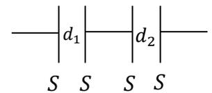
мы получаем батарею из двух последовательно соединенных конденсаторов, поэтому:
