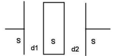
мы получаем батарею из двух последовательно соединенных конденсаторов, поэтому:
