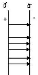
Если плоский конденсатор, обкладки которого имеют заряды фиксированной величины, полностью заполнить диэлектриком с диэлектрической проницаемостью  $\epsilon$ , то поле и разность потенциалов между обкладками уменьшатся в  $\epsilon$  раз, и, значит, емкость плоского конденсатора увеличится в  $\epsilon$  раз.
