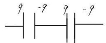
**тельными.** Последовательно соединенные конденсаторы можно рассматривать как новый конденсатор только, если соединенные между собой обкладки в целом электронеутральны!
