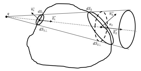
Построим очень узкий конус с вершиной в месте нахождения заряда q, пересекающий поверхность S, и найдем элементарные потоки через два очень маленьких (и поэтому практически плоских) участка поверхности, отсекаемых этим конусом на поверхности S:
