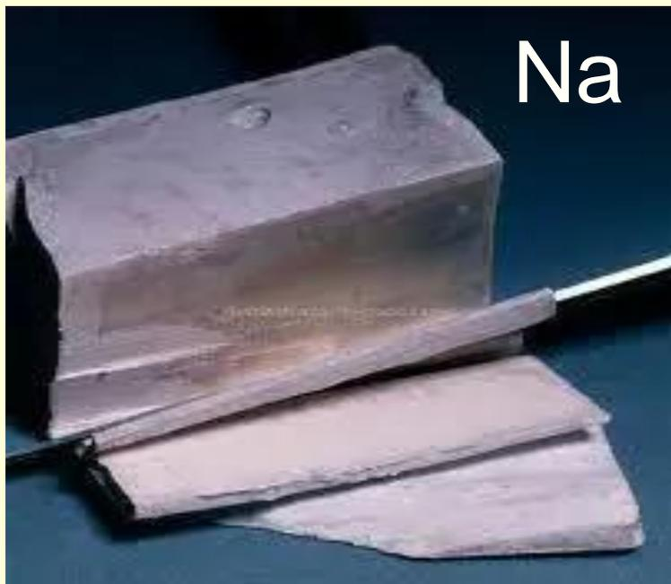
В узлах кристаллической решетки атомы и катионы металла. Валентные электроны обобществлены, образуют «электронный газ»
