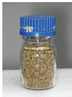
Рис. 4. Фосфор образует несколько сульфидов. Один из них состава \text{P}_4\text{S}_3 представлен на фото ( https://en.wikipedia.org )
