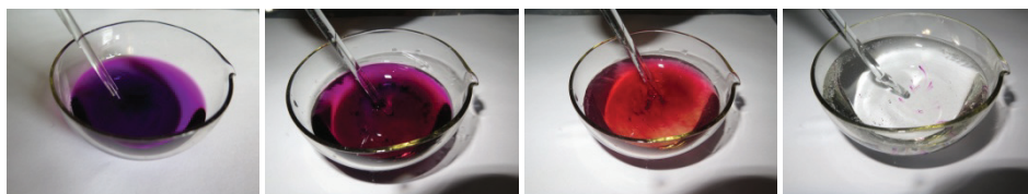
Рис. 6. Реакция перманганата калия с перекисью водорода в присутствии фосфорной кислоты. При добавлении перекиси малиновая окраска перманганата сменяется вишнево-красной, обусловленной фосфатными комплексами марганца (III), а затем исчезает. (Фото автора)
