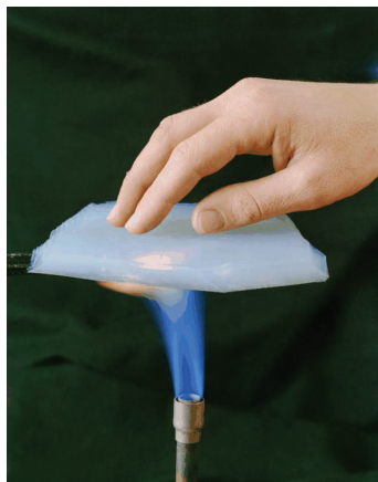
Рис. 7. Аэрогель – прекрасный теплоизолятор ( http://miridei.com/ )
