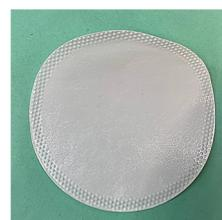
**Рис. 1б.** *Ультрафильтрационная мембрана из полиакрилонитрила*
