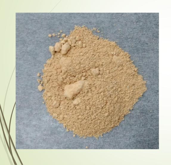
FeCl<sub>2</sub> - реактив, необходимый при проведении некоторых экспериментов, СВЯЗОННЫХ С ПОЛУЧЕНИЕМ комплексов  $Fe^{2+}[1]$ , но не подлежащий длительному хранению, поэтому его предпочтительно синтезировать непосредственно перед экспериментом.
