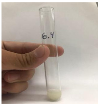
Рис. 3. Реакция пробы с 1% р-р нитрата серебра \text{AgNO}_3 с выпадением светло-желтого осадка
