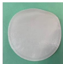
Рис. 1б. Ультрафильтрационная мембрана из полиакрилонитрила
