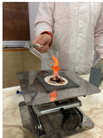
Рис. 5. Нагревание порции исследуемого масла с иодной водой
