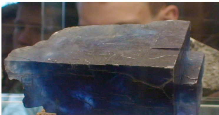
Образец \text{NaCl} , приобретший окраску из-за облучения и появления F-центров
