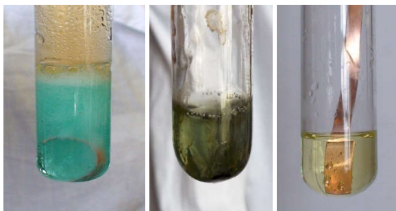
Взаимодействие меди с 30% \text{HNO}_3 , концентрированными \text{H}_2\text{SO}_4 и \text{HCl} (слева направо)
