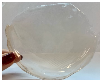
Рис. 6. Готовая плёнка ПВС-Ag
