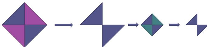
Рис. 214. Сокращение пробы методом квартования
