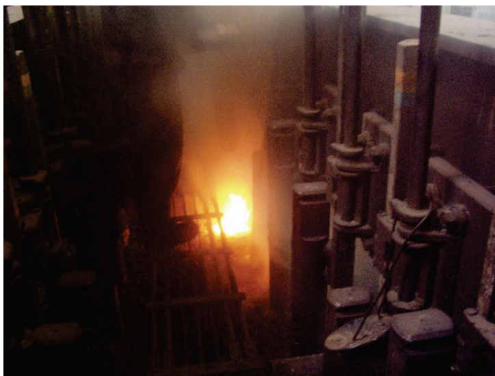
Замена токоподводящего штыря углеродного анода на алюминиевом заводе
