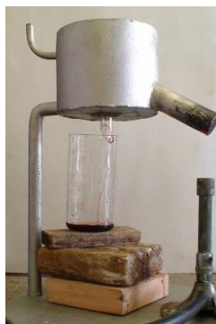
Воронка для горячего фильтрования. Сама воронка спряталась в кожухе, наружу торчит только ее короткий носик. Кожух заполняется водой через небольшое отверстие трубочки в левом верхнем углу и нагревается горелкой (для этого имеется специальный отросток справа)
