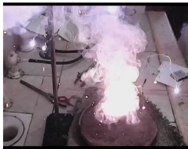
Алюминотермическое получение хрома
