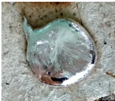
Застывающая капля цинка. Видно распространение процесса кристаллизации из точки, лежащей примерно на половине радиуса вверх и чуть левее от центра капли
