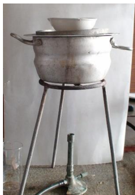
Процесс упаривания. Чашка с раствором вставляется в отверстие на крышке бани (сосуда, похожего на кастрюльку), заполненной водой. Баня подогревается горелкой или плиткой
