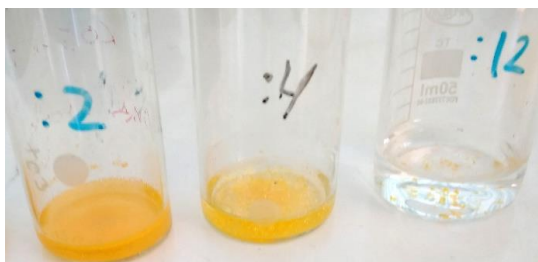
Выделение кристаллов иодида свинца (II) из разбавленных растворов
