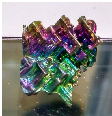
Висмут. Хорошо видны как кристаллические грани, так и чарующая окраска «радужного окисления»
