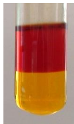
Экстракция брома деканом из водного раствора
