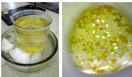
Кристаллики PbI_2 , выпавшие при резком охлаждении
