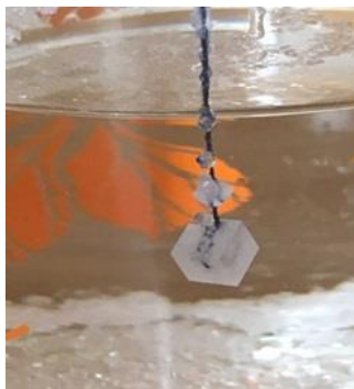
Кристалл, растущий в растворе. На нитке и на дне выросли лишние кристаллики, которые необходимо убрать
