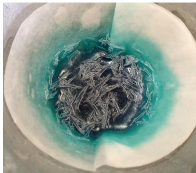
\text{CuSO}_4 \cdot 3\text{H}_2\text{O} , выделяющийся из горячего раствора
