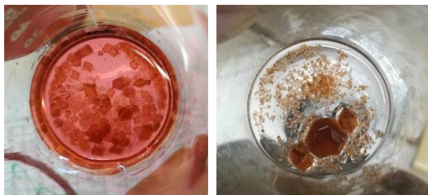
Кристаллы кобальт-аммониевого шёнита (\text{NH}_4)_2\text{Co}(\text{SO}_4)_2 \cdot 6\text{H}_2\text{O} , полученные при 24 °C (слева) и 33 °C (справа)
