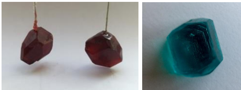
Кристаллы кобальт-аммониевого шёнита (NH_4)_2Co(SO_4)_2 \cdot 6H_2O (слева) и никель-аммониевого шёнита (NH_4)_2Ni(SO_4)_2 \cdot 6H_2O (справа)
