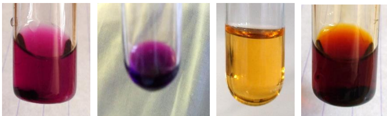
Растворы йода в неполярных \text{CCl}_4 , гексане; в полярных воде и спирте (слева направо)
