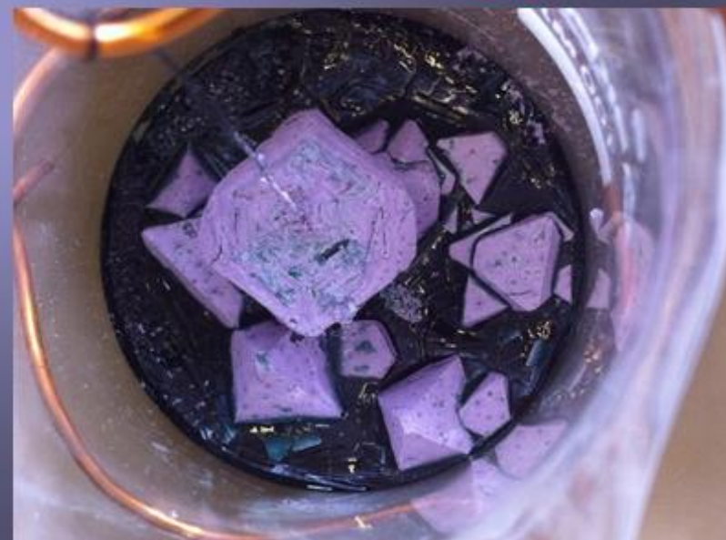
Хромокалиевые квасцы \text{KCr}(\text{SO}_4)_2 \cdot 12\text{H}_2\text{O}
