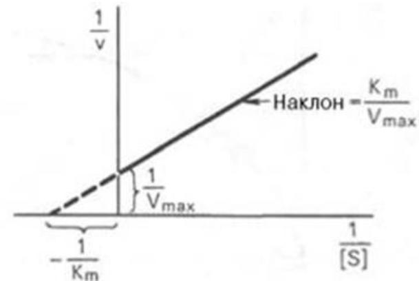
Рис.2: Зависимость  $1/V_0$  от  $1/[S]_0$  по модели Михаэлиса-Ментен
